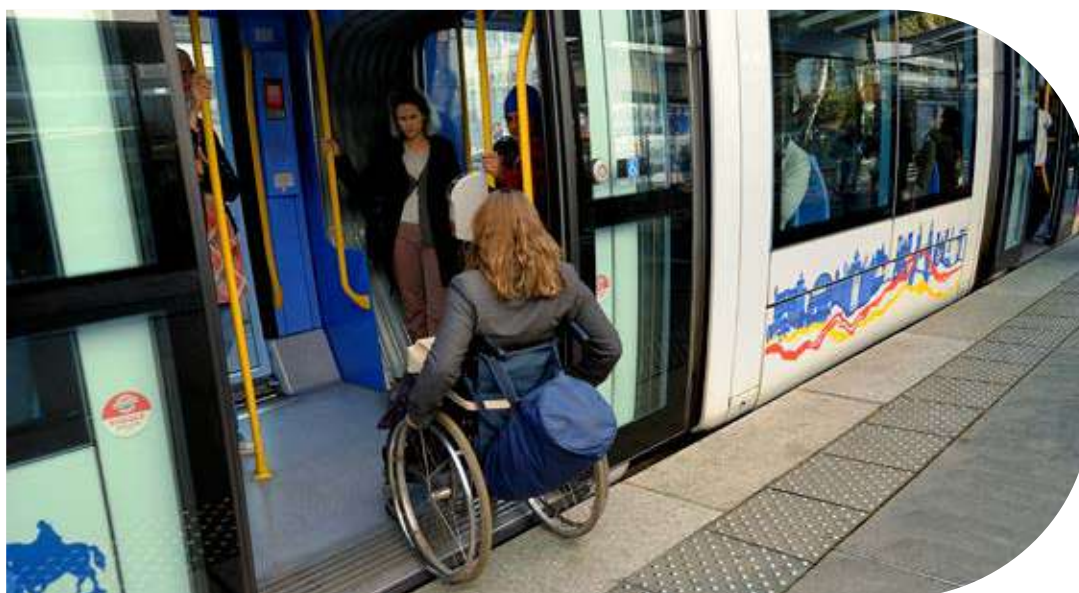
Matériel roulant permettant l'accès aux personnes à mobilité réduite dans les tramways de l'Agglomération Lyonnaise
