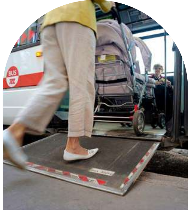
Rampe d'accès pour tous dans un bus du réseau TCL
